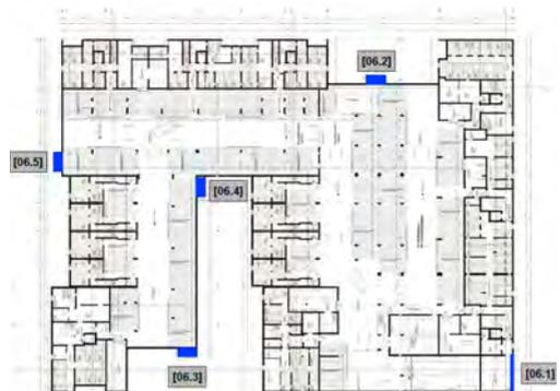
Tiefgaragenplan inkl. Lüftungskonzept (natürliche Belüftung)
